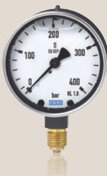
Манометр с трубкой Бурдона модели 213.40 имеет корпус из кованой латуни. Благодаря этому он чрезвычайно устойчив к механическим нагрузкам. Благодаря жидкостному наполнению манометр подходит для использования в измерительных точках с высокими динамическими нагрузками и вибрациями.
