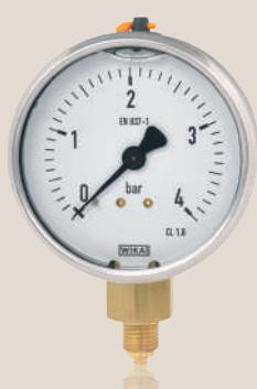
Манометр с трубкой Бурдона модели 113.53 имеет корпус из нержавеющей стали. Благодаря жидкостному наполнению манометр подходит для использования в измерительных точках с высокими динамическими нагрузками и сильными вибрациями.
