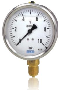
Манометр с трубкой Бурдона модели 213.53 в корпусе из нержавеющей стали подходит для измерения и индикации давления при повышенной температуре среды. Заполнение жидкостью обеспечивает высокоточную индикацию при скачках динамического давления и вибрациях.
