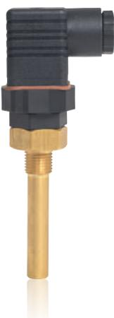
Модель TFS35 представляет собой биметаллическое реле температуры и может быть выполнена с нормально замкнутым или нормально разомкнутым контактом. Благодаря высокой электрической коммутируемой мощности реле может быть встроено в цепь нагрузки без промежуточного реле. Это означает, что ни дополнительный источник напряжения, ни входной сигнал для управляющей электроники не требуются.
