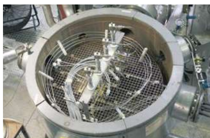
LOCA тест (испытание на стенде в условиях аварии ядерного реактора с потерей теплоносителя)
