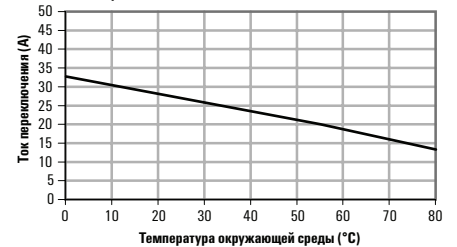
Кривая ухудшения характеристик без вентиляции и при постоянной работе
