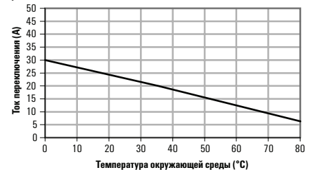
Кривая ухудшения характеристик без вентиляции и при постоянной работе
